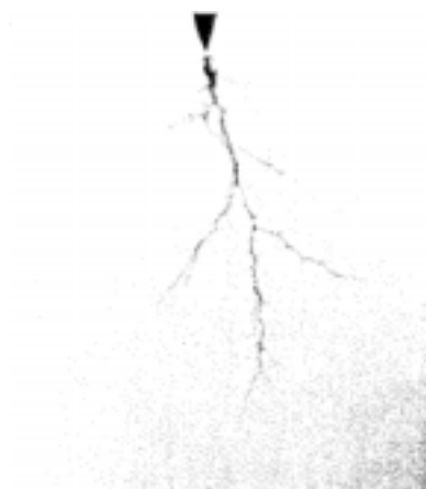
图 2.13 实际直流电压下的电树图像
