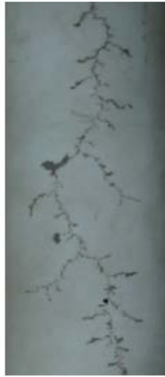
图 2.12 实际冲击电压下的电树图像
