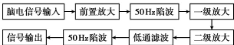
图 1 EEG 放大器电路设计总体框图
