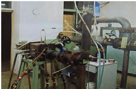
图4 MHD 控制推力矢量试验台
