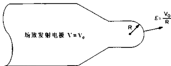
图 5.5 半径为 R 、负电位为 V_0 的微细点的场致电子发射; 其表面电场由外加电压除以尖端的有效半径而得
