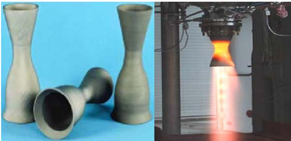
图 13 C/SiC 复合材料推力室身部及其地面热试
